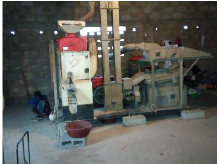
Photo 4 : Décortiqueuse à moteur utilisée dans l'un des moulins traditionnels du village
