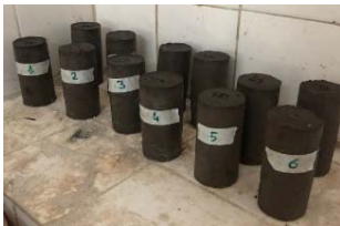
Photo 8 : Séchage du béton géopolymère
