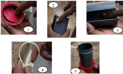
Photo 7 : Préparation de la moule cylindrique
