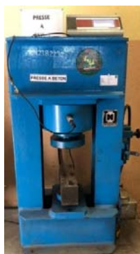
Photo 9 : Presse hydraulique d'essai de compression du béton
