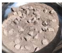
Photo 6 : Mélange de l'Aluminosilicate, du sable et des graviers
