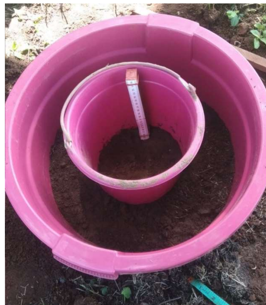
Figure 6 : infiltromètre double anneau fabriqué sur place
