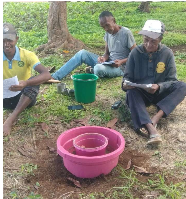
Figure 5 : Techniciens effectuant les essais d'infiltration au point centre
