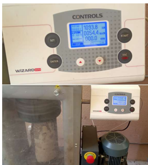
Photo 10 : Matériels pour les tests à la compression et à la rupture
