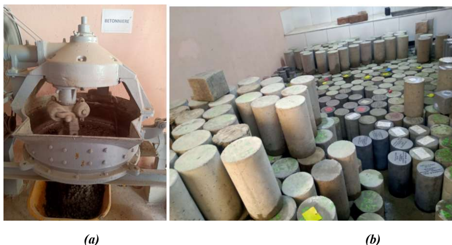
Photo 9 : (a) Bétonnière, (b) chambre froide pour la conservation des échantillons
