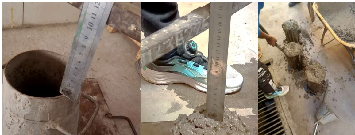
Photo 7 : Mesure d'Affaissement au cône d'Abrams et utilisation de pervibrateur
