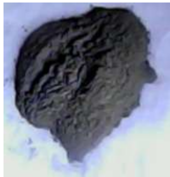
Photo 3 : poudre fine d'ardoise, 80 µm
