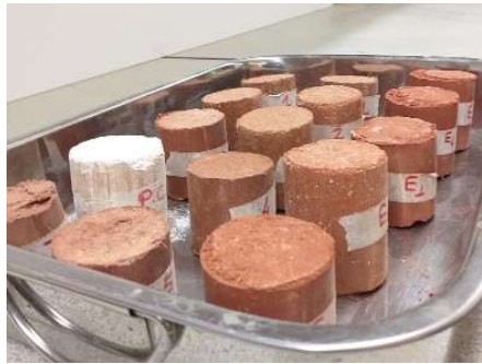
Figure 6 : éprouvettes d'expérimentation, cylindrique
