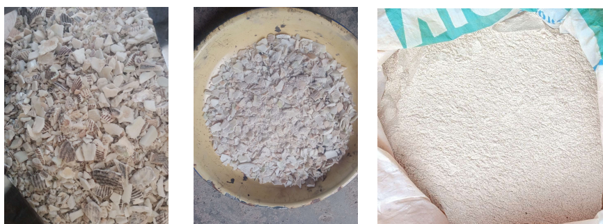
Figure 4: coquillages concassés - broyés – tamisés
