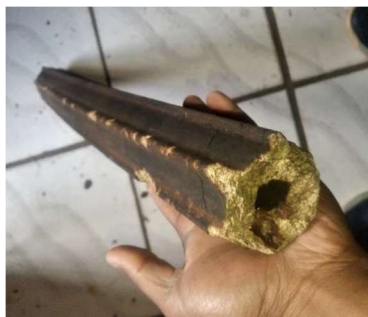
Photo 3 : Briquette extrudée et pellet de la société Biogasikara à Moramanga
