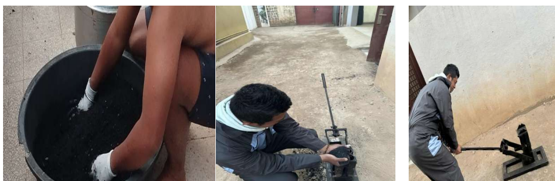
Photo 1 : Etapes de production de briques de fines de charbon de bois
