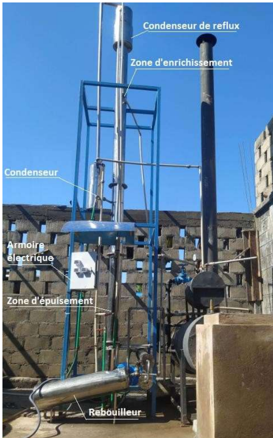
Figure 4: Photo de la colonne de distillation en continue
