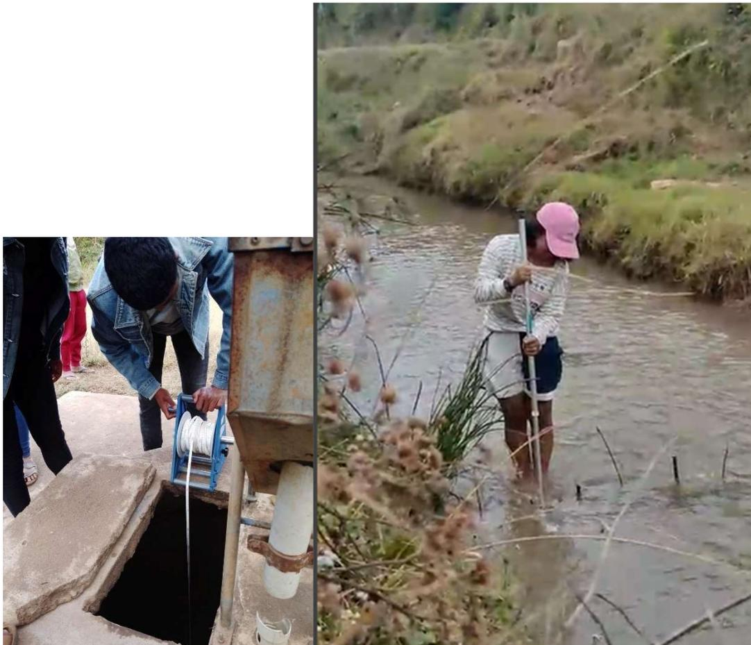
*figure 3 Mesure piézométrique manuelle d'un puit effectuée par les étudiants de la mention Génie de l'eau de l'UDI*
