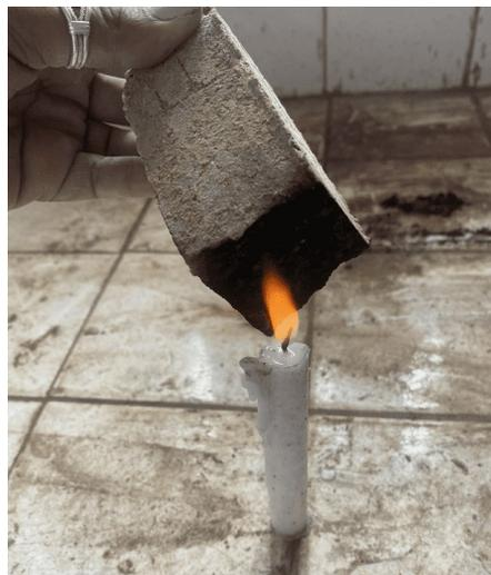
**Photo 8: Essai de comportement au feu des panneaux de particule**
