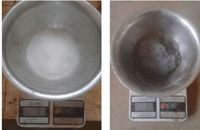
**Photo 1: Pesage de chaque constituant de silicate de soude (SS)**
