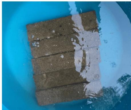
**Photo 10: Test d'immersion dans l'eau**
