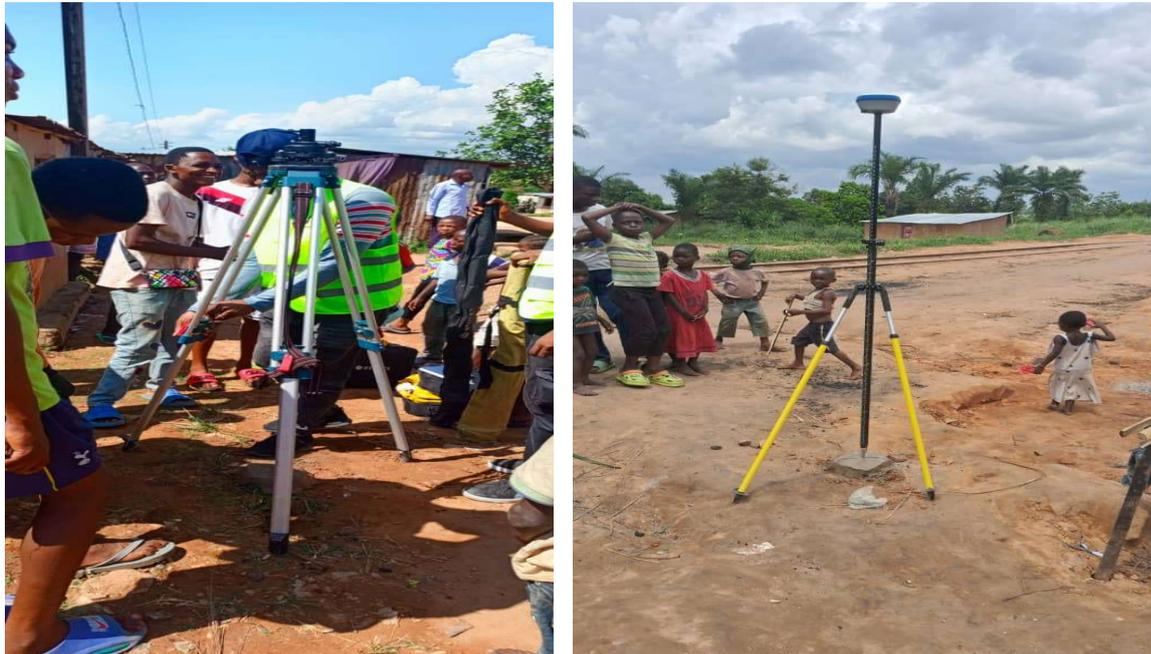
Fig. n° 2 : illustration de la mise en station du récepteur et du lancement des observations
