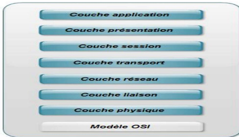
Figure I.5: Les couches du modèle OSI.
