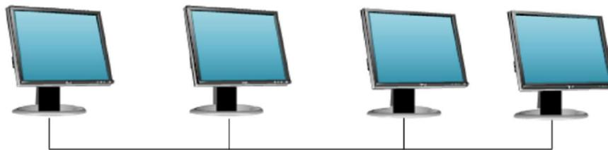
**Figure .I.2 : topologie en bus**
