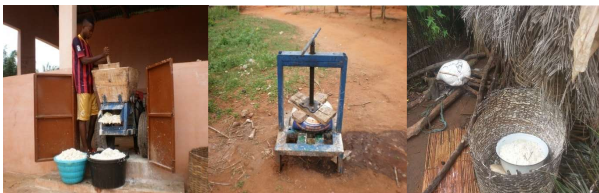
Planche 5 : Râpage des tubercules de manioc épluché et pressage de la pâte du manioc à l'unité de production du GF "Lebeni" à Banigbé
