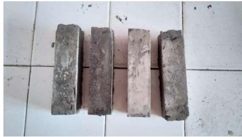
Figure 9 : Eprouvette obtenue après démoulage
