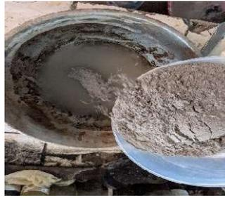
*Figure 2 : Ajout d'une cendre dans la solution de soude*
