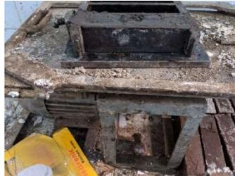
*Figure 8 : Moulage sur la table vibrante*
