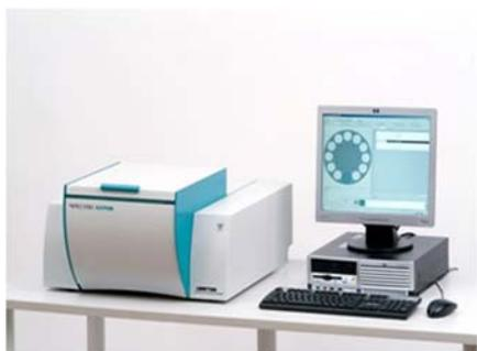
La Calcium a été mesuré à l'aide du spectromètre de fluorescence X, version énergie dispersive (ED-XRF), XEPOS III, en utilisant la méthode « FP-Water » du spectro Ametek.
