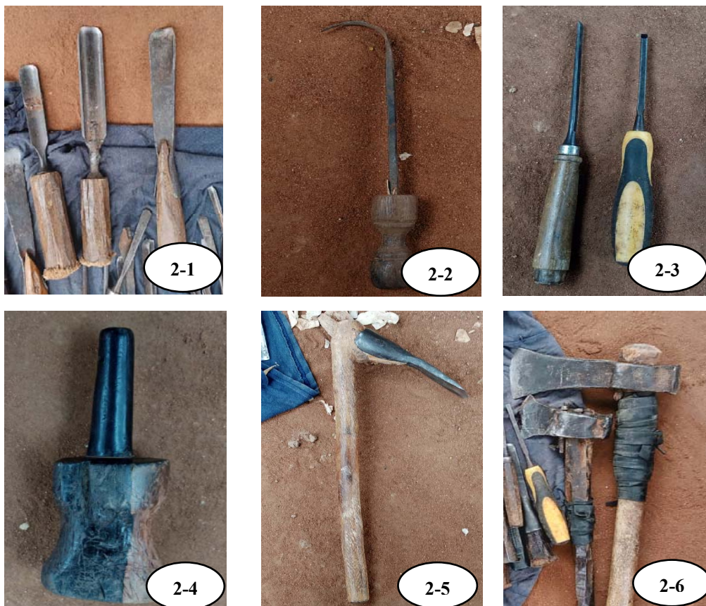
2-1- Des gouges ; 2-2- un couteau croche rond ; 2-3- des ciseaux ; 2-4- un maillet de sculpteur en forme de cloche ; 2-5- une herminette pour sculpteur ; 2-6- des haches
