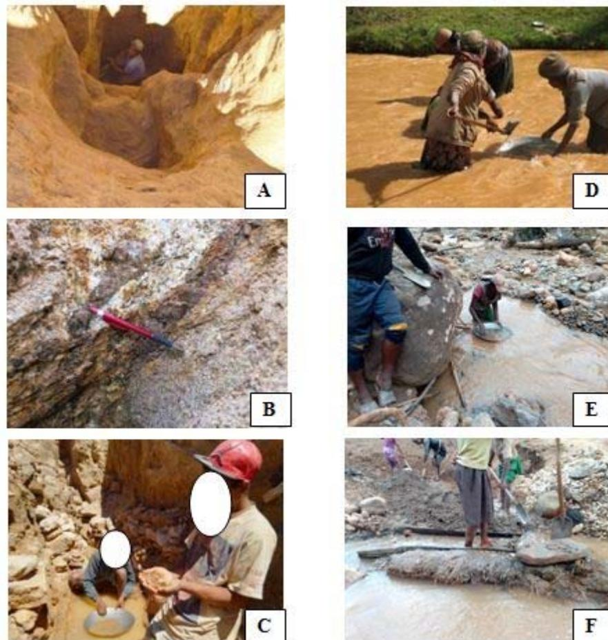
Figure 3: Photos illustrant les principaux types de gisement d'or et leurs modes d'exploitation. A : Puits miniers dans les gisements primaires B: Filons de quartz aurifères C : Concassage et lavage des veines de quartz aurifère. D, E : Exploitation par batée dans les lits vifs. F: Orpaillage sur les berges des cours d'eau.
