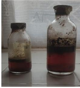
Fig. 6. Fractions condensables recueillies : essai 05 à gauche et essai 10 à droite
