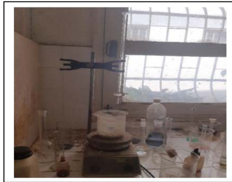
Figure 8 : Détermination de valeur de bleu de méthylène
