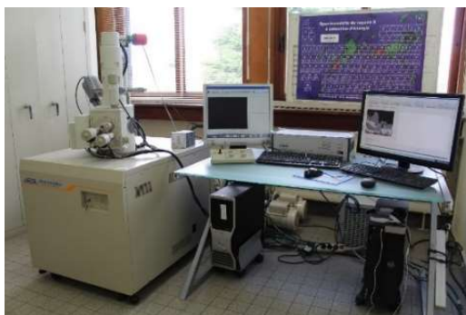
Photo 5 : Microscope à Balayage (MEB) Electronique JEOL JSM-6380LV + EDS RONTEC
