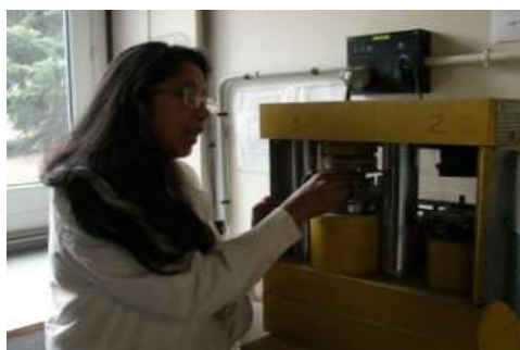
Photo 10 : Mesure de la résistance à la flexion et à la compression (LMDC)
