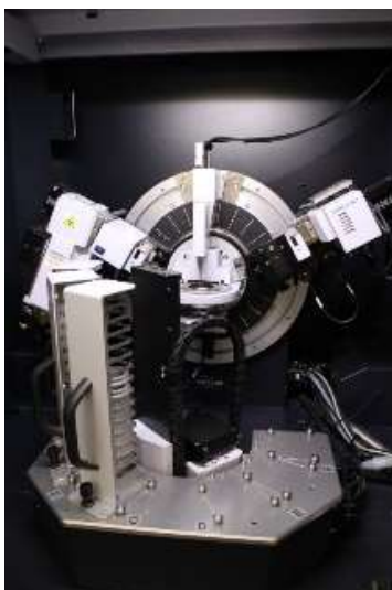
Photo 4 : Diffractomètre à Rayons X (DRX) SIEMENS Röntgengenerator KRISTALLOFLEX 710D- avec passeur d'échantillon (LMDC)
