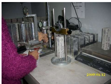
Photo 11 : Mesure du retrait (LMDC)
