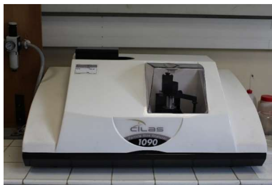
Photo 6 : Finesse : Granulomètre laser CILAS 1090 Liquide
