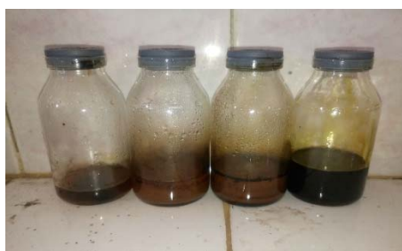
Photo 2 : Huile obtenu par la pyrolyse de balle de riz.
