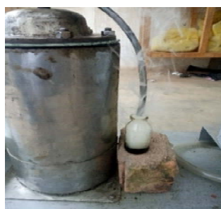
Photo 1 : Dégagement de fumée et mise en bouteille de l'huile durant la pyrolyse.
