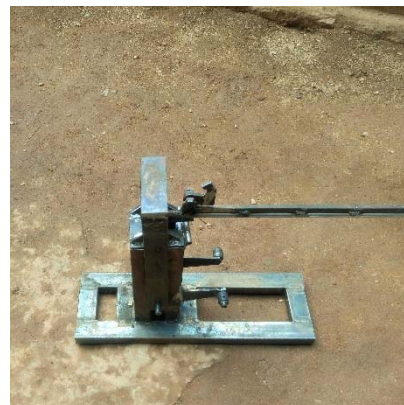
Photo5: Prototype de presse à briquettes manuelle, à 4 moules
