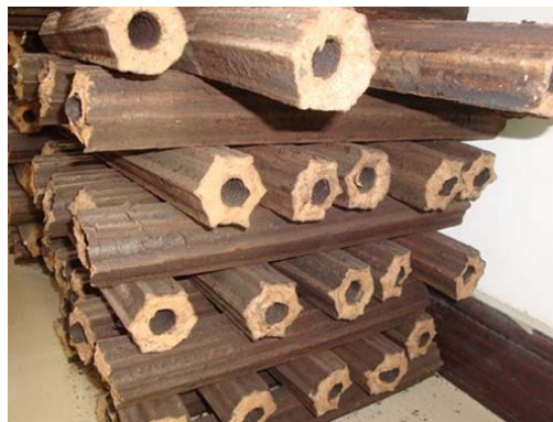
Photo 4: Briquettes combustibles de modèle extrudé
