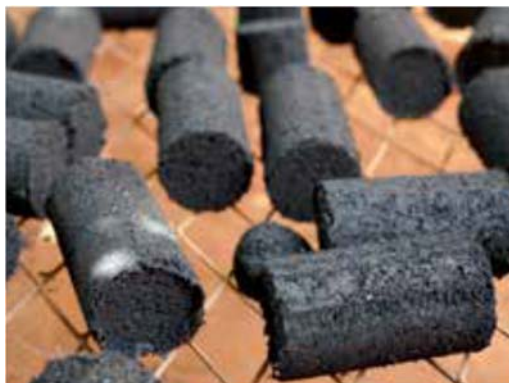
Photo 3: Briquettes écologiques de modèle cylindrique à partir de résidus de scierie
