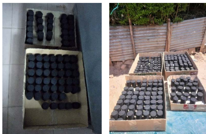
Photo 6 : Modes de séchage des briquettes de sciure de bois cylindriques
