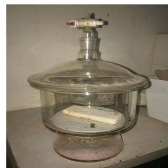
Photo 18 : Dessiccateur en verre avec déshydratant de gel de silice
