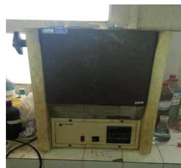
Photo 17 : Four à moufle électrique équipé d'un contrôleur de température programmable
