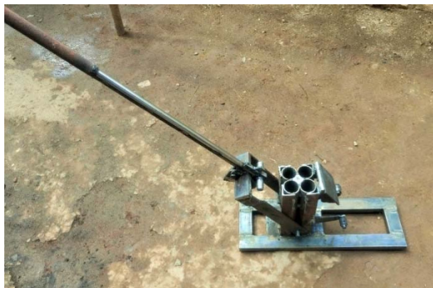
Photo5: Prototype de presse à briquettes manuelle, à 4 moules
