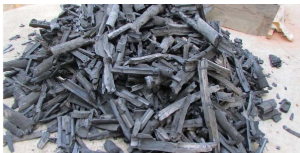
Photo 2 : Charbon de bambou issu d'un four à charbon de bois à dôme
