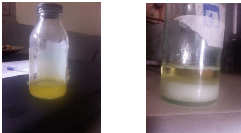
Photographie 8: Comparaison de l'huile transestérifiée à un taux de KOH 0,5% et à un taux de KOH 2% (à gauche : taux de KOH 0,5% ; à droite : taux de KOH 2%)
