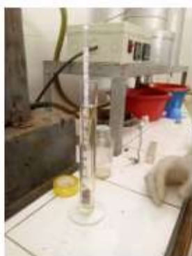
Mesure du degré alcoolique du mélange de distillat de la première distillation
