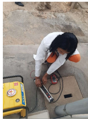
Mesure de la tension à la sortie du groupe
