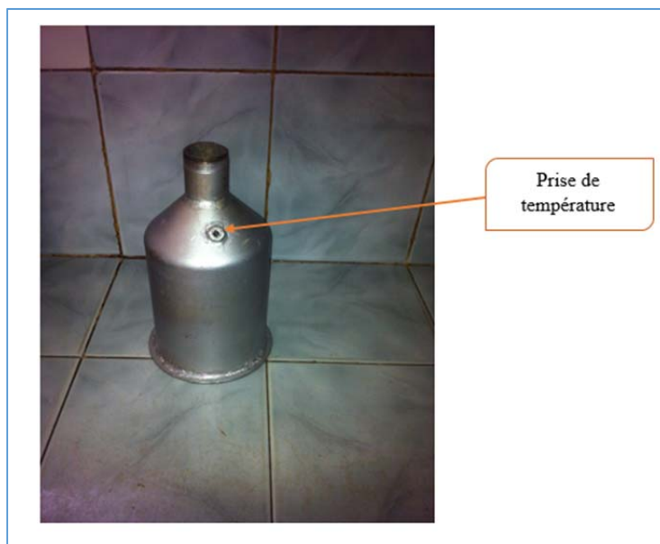
Fig. 7 : Forme réelle du bouilleur
