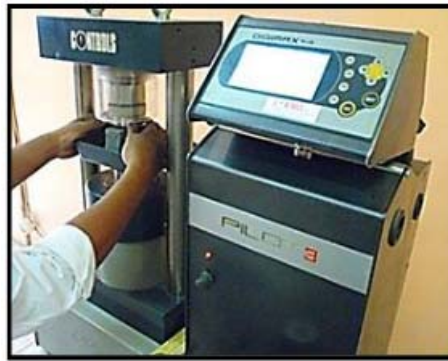
Photo 5: Mesure de la résistance à la compression.
