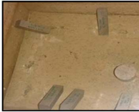
Photo 4: Conservation des éprouvettes.
