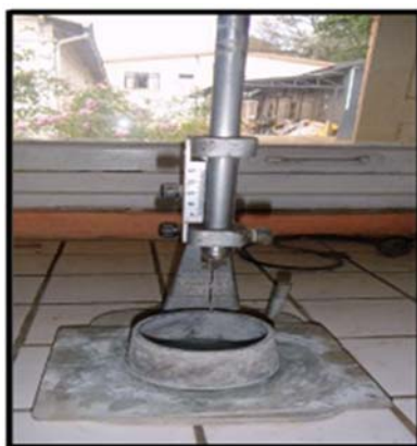
Photo 6: Appareil de Vicat avec un moule tronconique.
