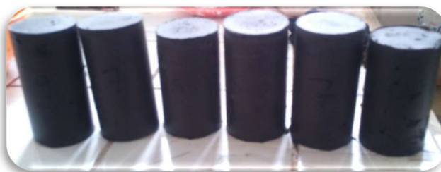
Photo 28 : conservation à l'air libre des éprouvettes géopolymères
