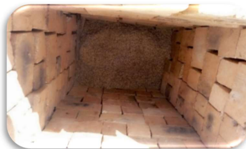
Photo 4 : Introduction de la balle de riz dans l'incinérateur
