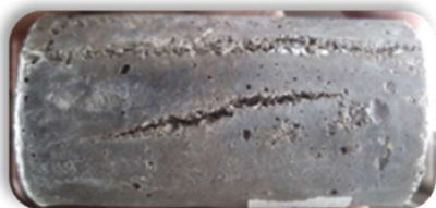
Photo 24 : Fissures au niveau des éprouvettes
