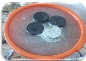
Photo 23: Éprouvettes immergées dans une solution de HCl à 5%
