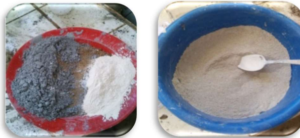
(a) (b) Photo 22 : (a) Mélange CBR+MK+ sable (b) homogénéisation du mélange
