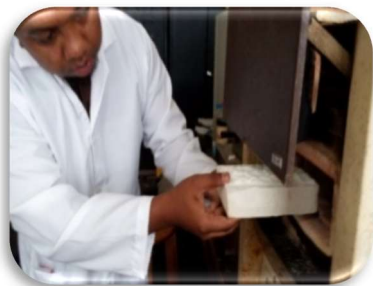
Photo 1 : Introduction du kaolin dans un four électrique
