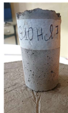
Photo 26 : Eprouvette géopolymère après 7 jours d'immersions dans la solution HCl à 10 %
