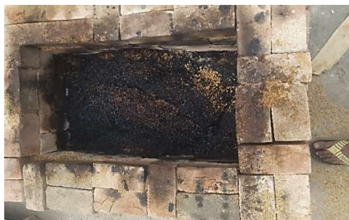
Photo 7 : Balle de riz au cours de la carbonisation
