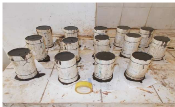
Photo 27 : Séchage des éprouvettes après moulage
