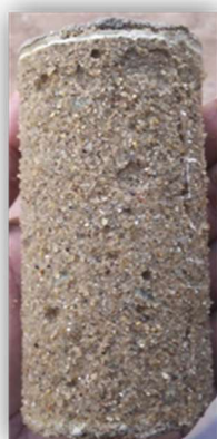
Photo 25 : Eprouvette témoin après 14 jours d'immersions dans la solution H 2 SO 4 à 10%
