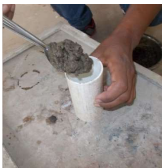
Photo 26 : Moulage et serrage des éprouvettes sur une table vibrante
