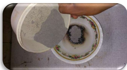
Photo 19: Mélange de cendres de balle de riz et de la solution de soude
