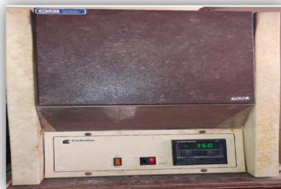
Photo2 : Température de cuisson du kaolin
