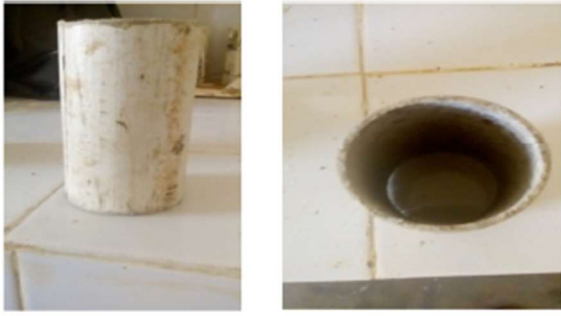
Photo 13 : Moule cylindrique d'élancement 2 ( \Phi = 5\text{cm} et h = 10\text{cm} )
