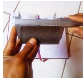
Photo 17 : Mesure des dimensions à l'aide d'un pied à coulisse
