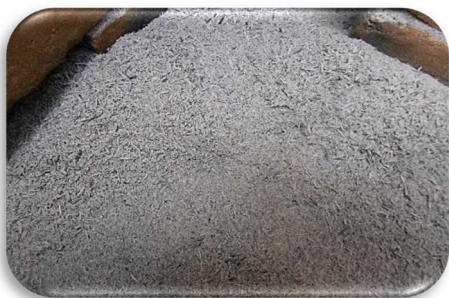
Photo 8 : Cendre de balle de riz obtenue après incinération
